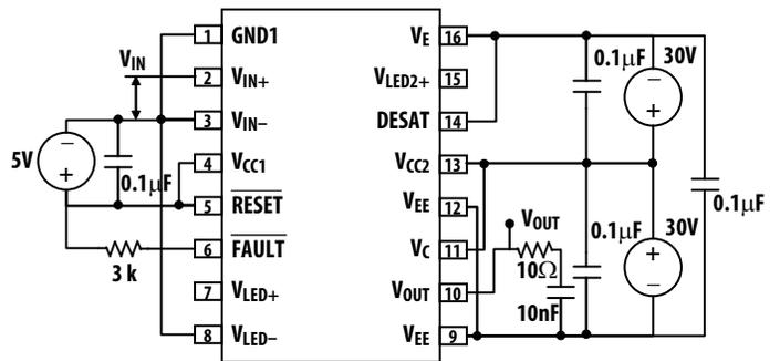
Figure 44.  $t_{PLH}$ ,  $t_{PHL}$ ,  $t_r$ ,  $t_f$  test circuit.
