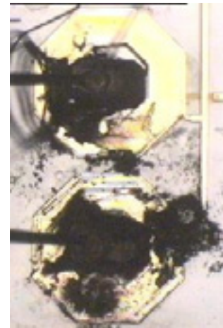
図 5、他社（A 社）製磁気アイソレータの焼損跡
