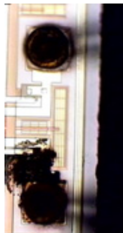
図 5、他社（A 社）製磁気アイソレータの焼損跡
